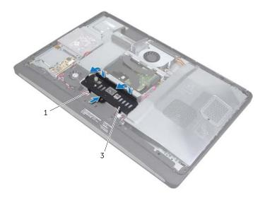
1 linguette di fissaggio 2 Pannello d'I/O
